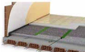
Sección de un forjado donde se indica el material elástico antimpacto
