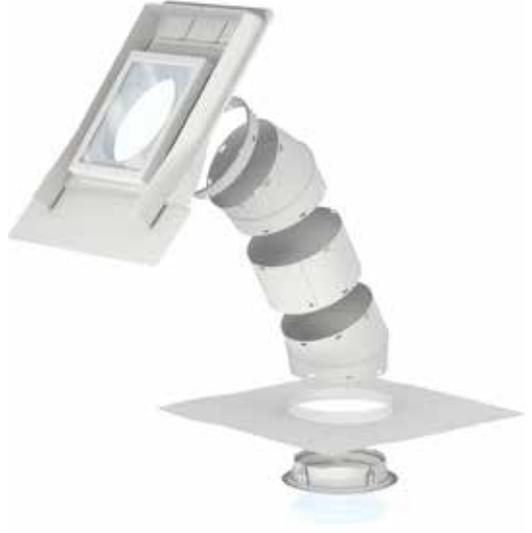
Lleva luz natural dentro de locales sin ventanas o poco iluminados, en los que no es posible instalar ventanas. Está formado por un captador instalado sobre la cubierta que recoge la luz, la transporta al interior de los ambientes situados debajo de él y la distribuye a través de un difusor. Pendiente: De 15° a 60°.
