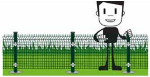
3. Instalar el frontal del soporte Fax en la cremallera del poste Lux y colocar el panel por delante del soporte.
