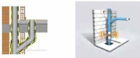
· La incorporación de un trasdosado es muy eficiente acústicamente, pero un segundo trasdosado no proporciona una mejora del doble de aislamiento.
