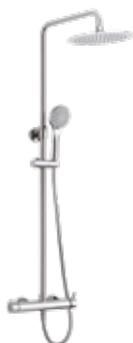
Monomando. Rociador de acero inoxidable de 25 cm. Derivador integrado en el grifo. Flexo de pvc plateado mate y teleducha de 3 posiciones. Altura regulable entre 83 y 127,5 cm.
