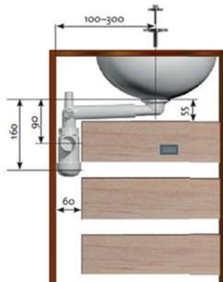
Kit sifón + válvula clic-clac cromada + tubo flexible. Sifón ahorra espacio. Queda alojado detrás de los cajones haciendo innecesaria la "U". Se puede instalar en cualquier mueble que tenga mínimo 6 cm detrás de los cajones. Orientable y extensible. Pre-montado. Fácil instalación.
