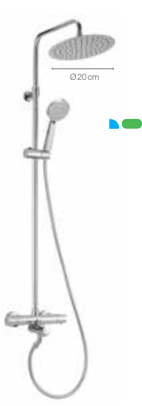
A Senna termostático (baño-ducha) Ref. VSENN030B sin IVA 481,95 € Altura: entre 109 y 179 cm Cartucho termostático. Rociador de ABS: Ø20 cm Flexo de PVC plateado, teleducha de 3 posiciones y soporte regulable en altura. Caño para llenado de la bañera.
