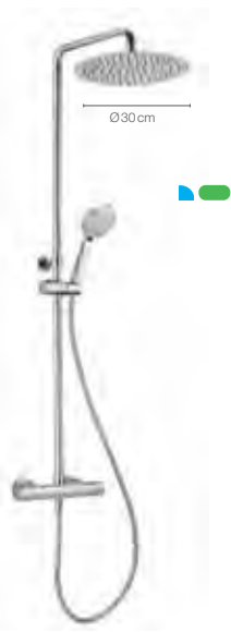
A Senna plus termostático Ref. VSENN100B sin IVA 349,95 € Altura: entre 81 y 131 cm Cartucho termostático. Rociador de acero inoxidable: Ø30 cm. Flexo de PVC plateado, teleducha de 3 posiciones y soporte regulable en altura. Derivador integrado en el cuerpo.
